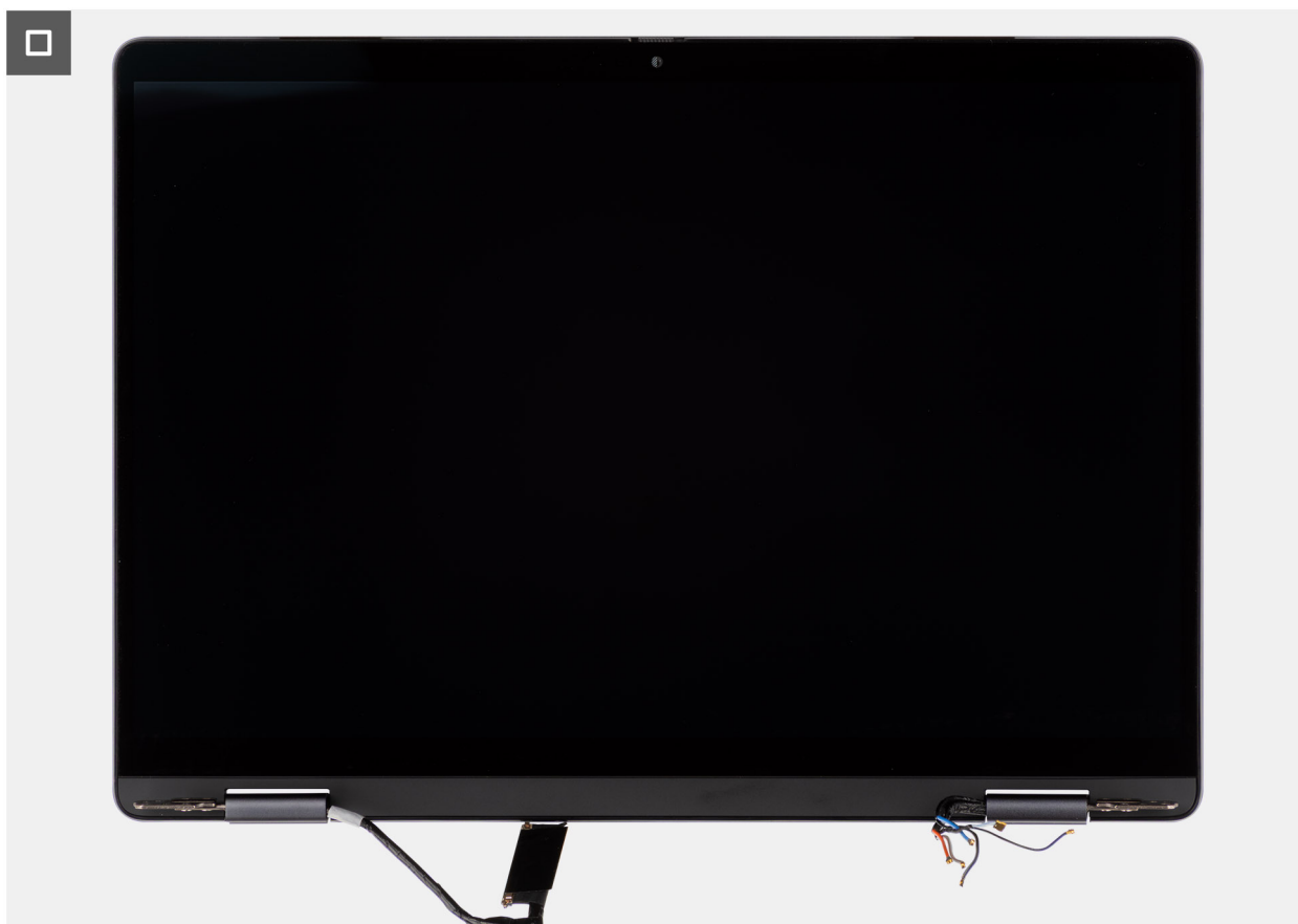
Rysunek 33. Display assembly
