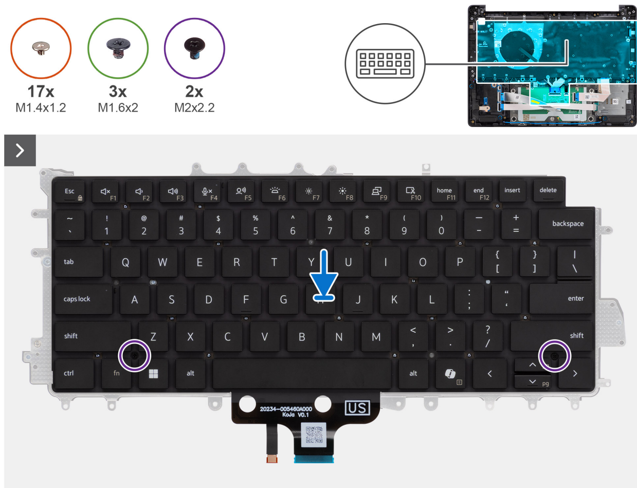
Rysunek 68. Installing the keyboard
