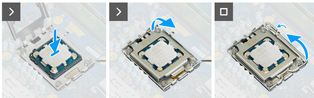
Rysunek 60. Instalowanie procesora
