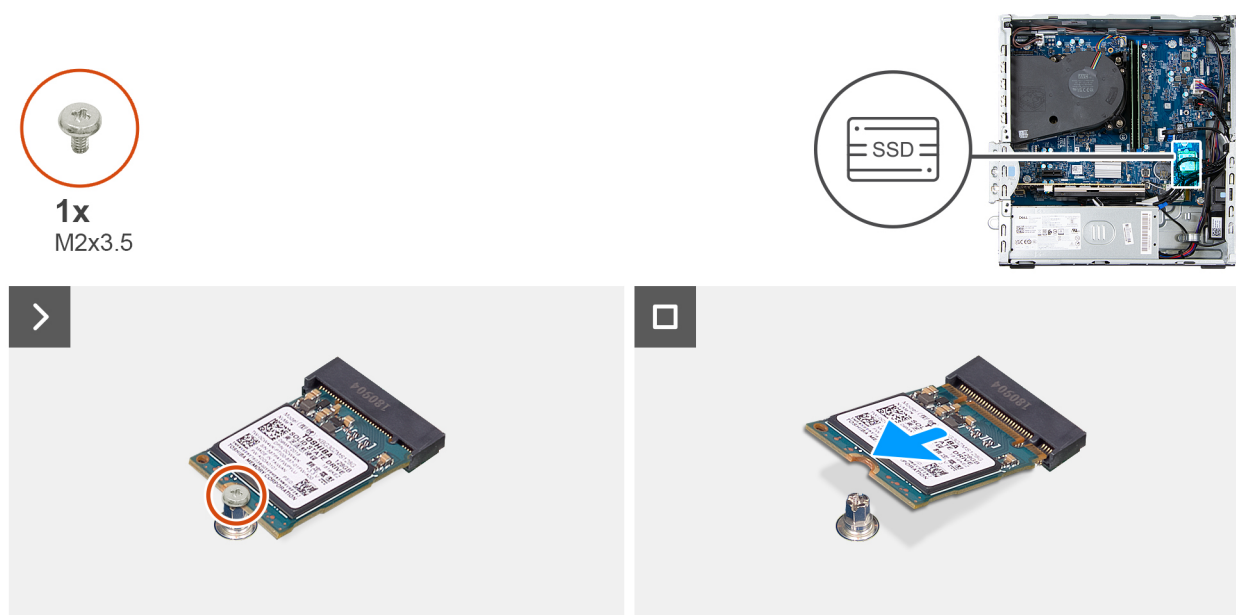
Rysunek 22. Wymontowywanie dysku SSD M.2 2230
