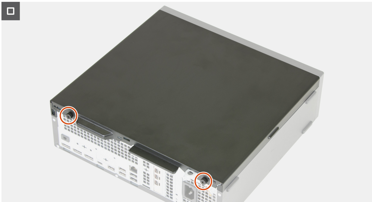
Rysunek 9. Instalowanie pokrywy bocznej
