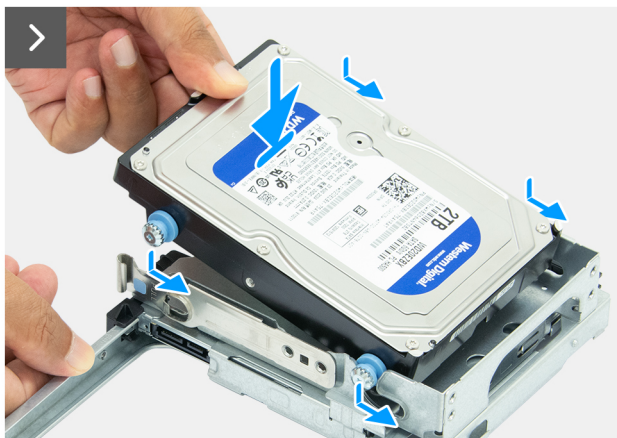
Rysunek 40. Instalowanie dysku twardego
