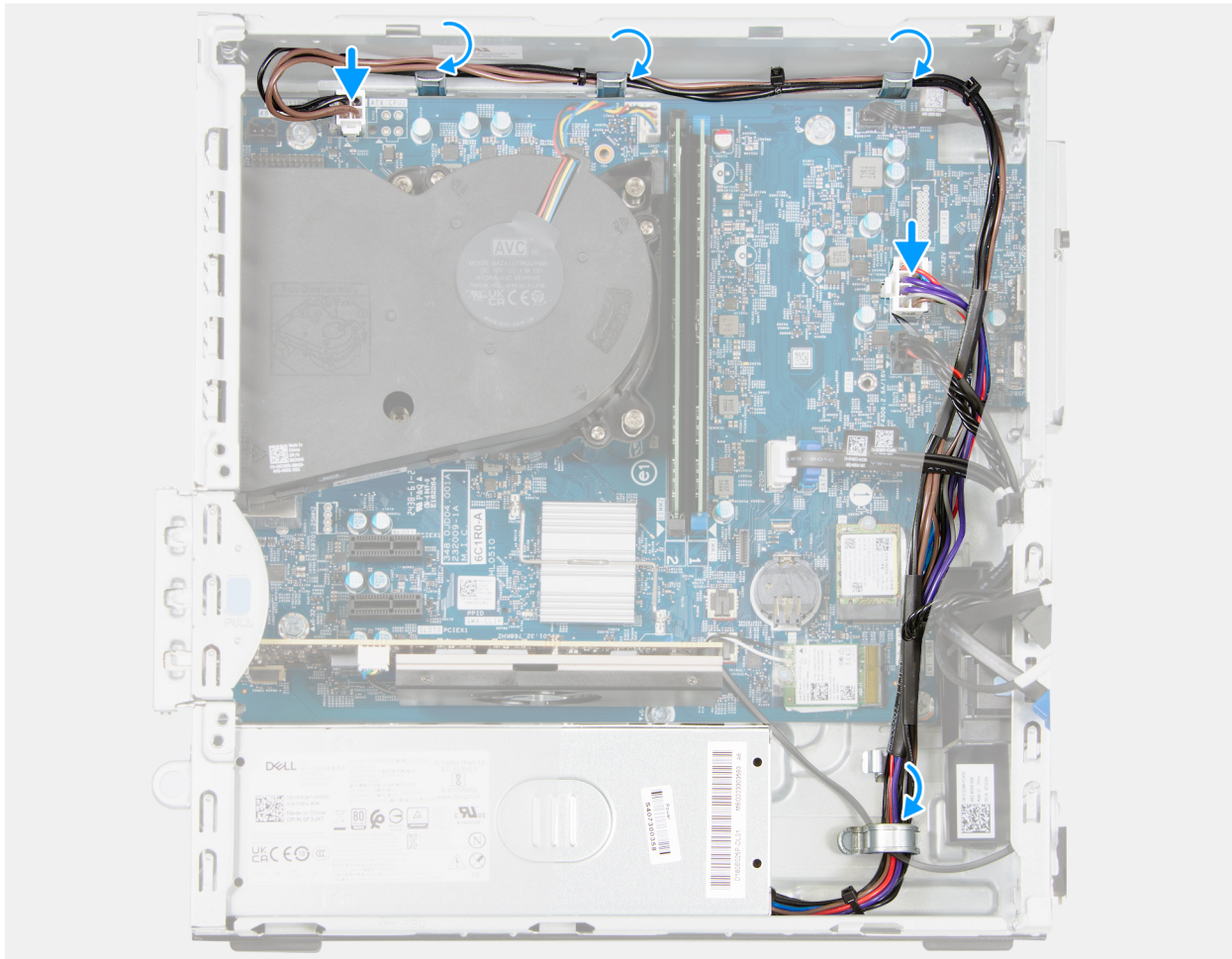
Rysunek 50. Instalowanie zasilacza
