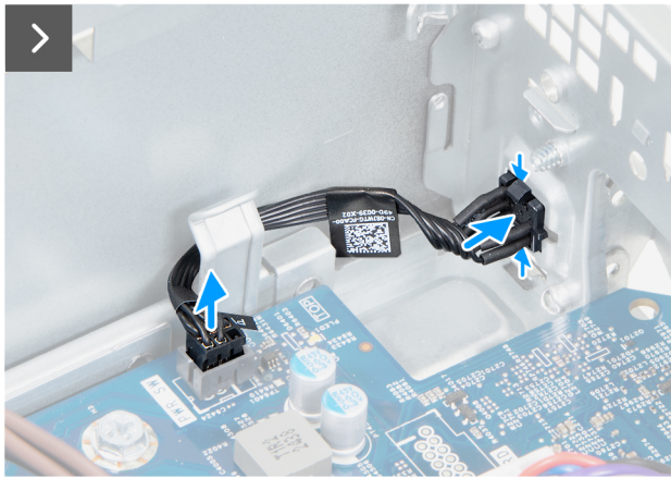
Rysunek 43. Wymontowywanie przycisku zasilania
