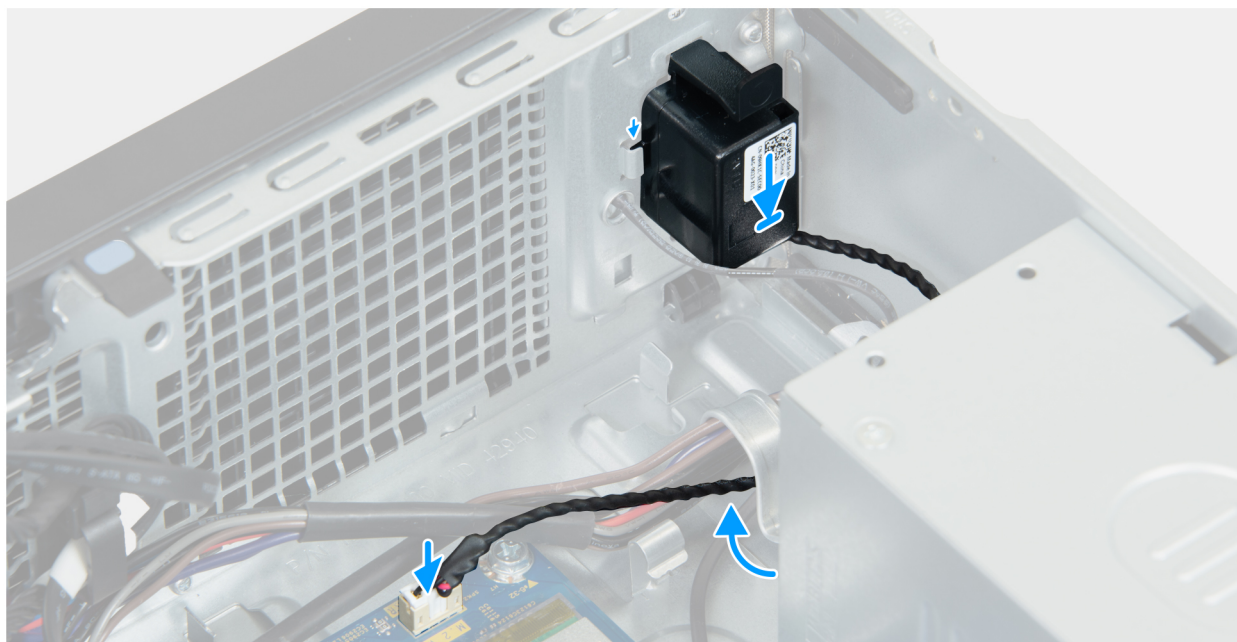
Rysunek 19. Instalowanie głośnika wewnętrznego
