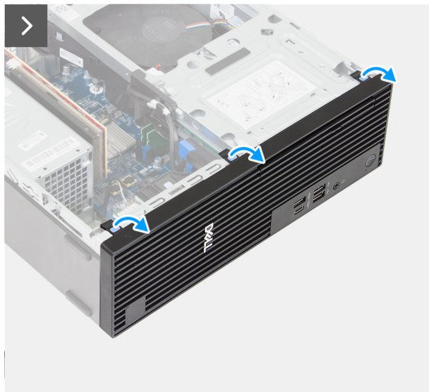
Rysunek 16. Wymontowywanie pokrywy przedniej
