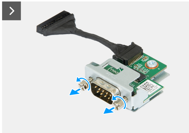
Rysunek 57. Instalowanie modułu portu szeregowego
