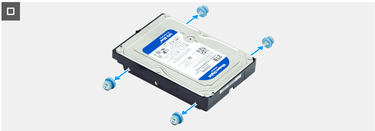
Rysunek 39. Wymontowywanie dysku twardego
