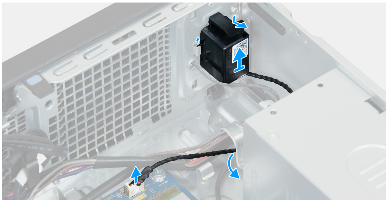
Rysunek 18. Wymontowywanie głośnika wewnętrznego
