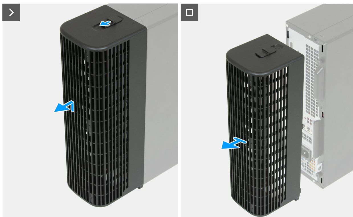
Rysunek 4. Wymontowywanie osłony kabli
