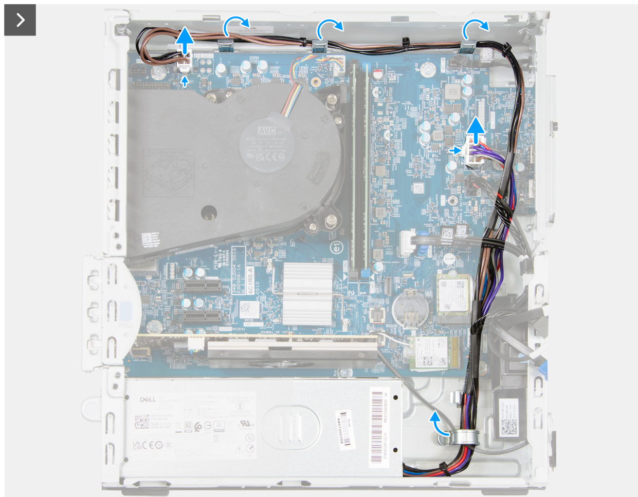
Rysunek 47. Wymontowywanie zasilacza
