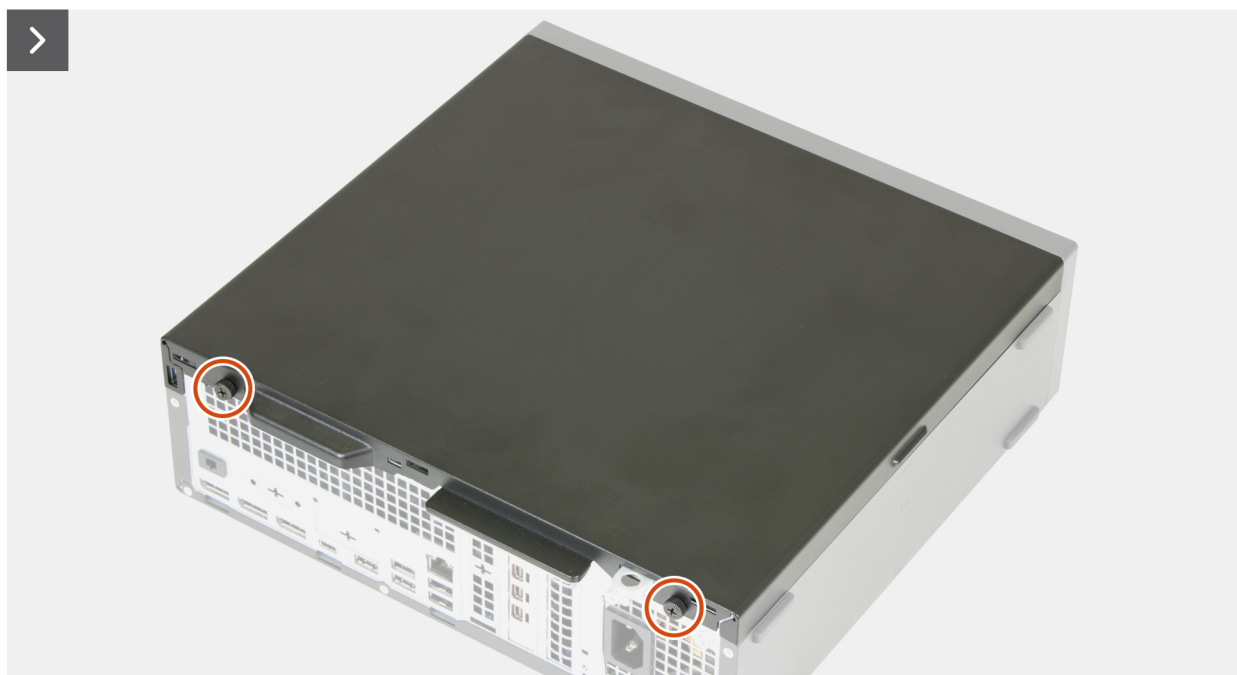
Rysunek 6. Wymontowywanie pokrywy bocznej
