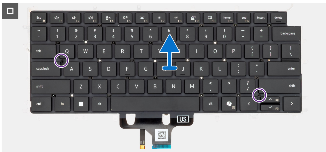
Rysunek 70. Wymontowywanie klawiatury
