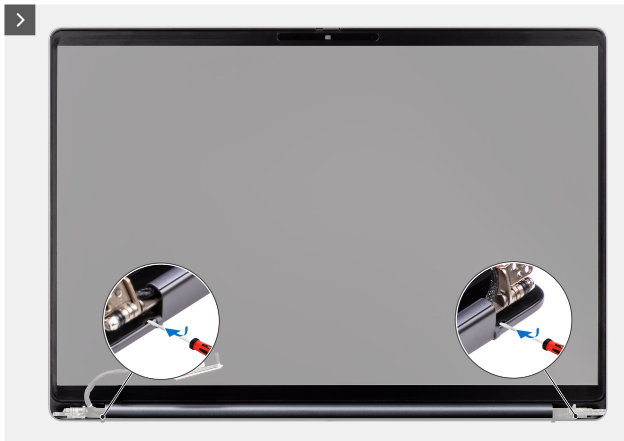
Rysunek 41. Wymontowywanie ramki wyświetlacza
