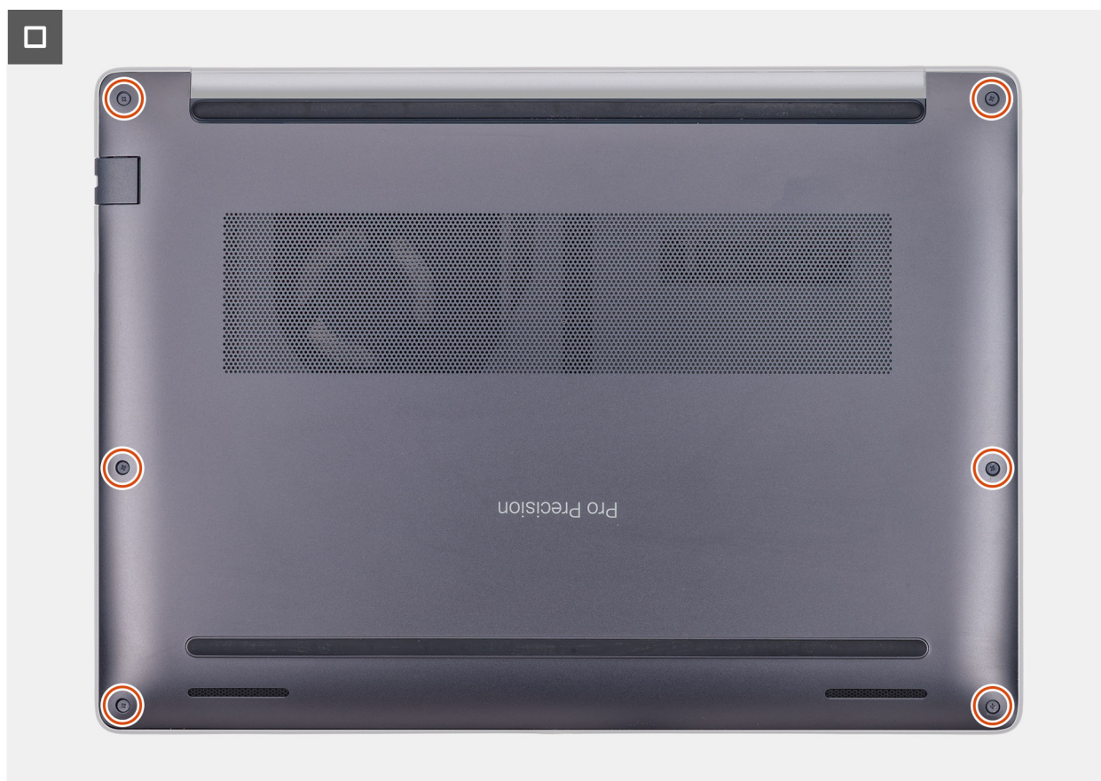
Rysunek 9. Instalowanie pokrywy dolnej
