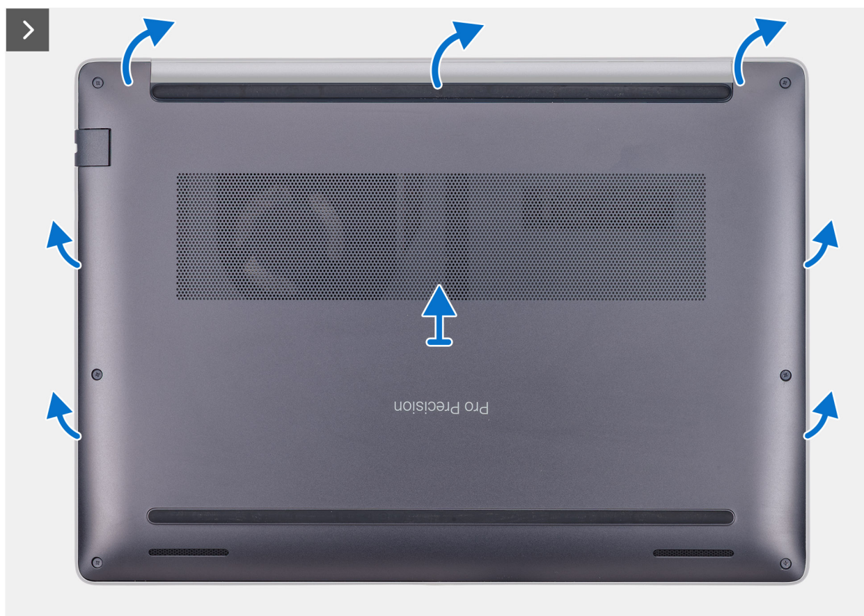
Rysunek 5. Wymontowywanie pokrywy dolnej
