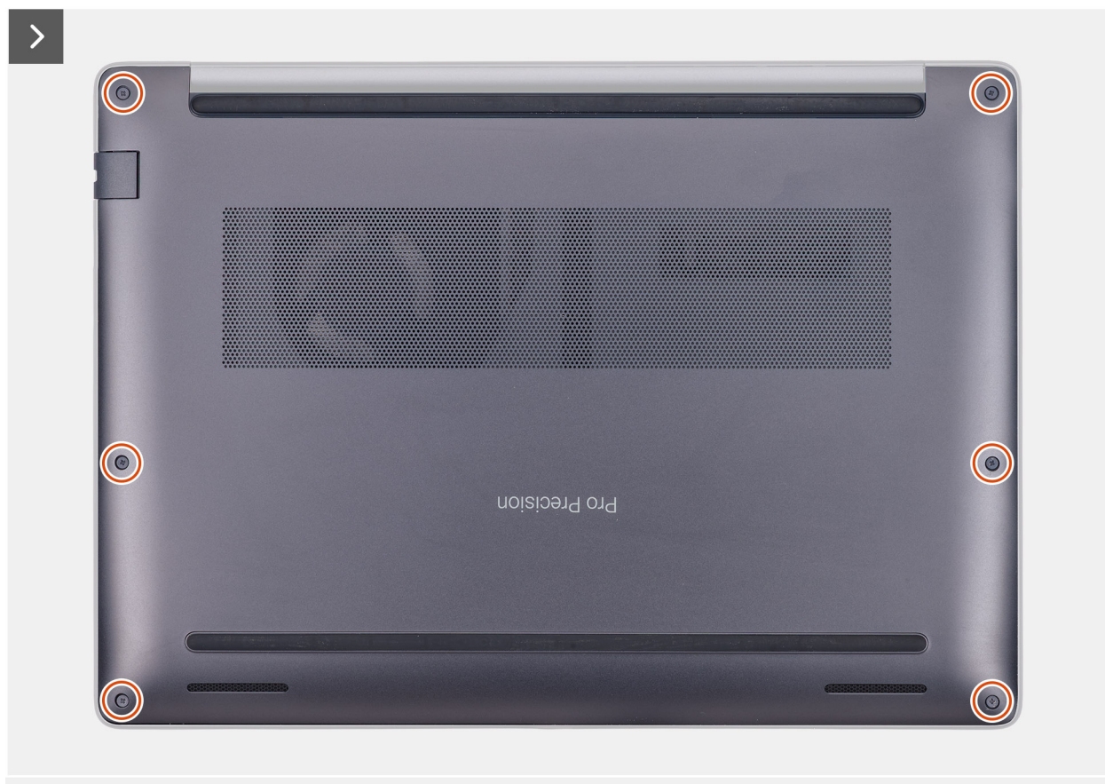
Rysunek 4. Wymontowywanie pokrywy dolnej
