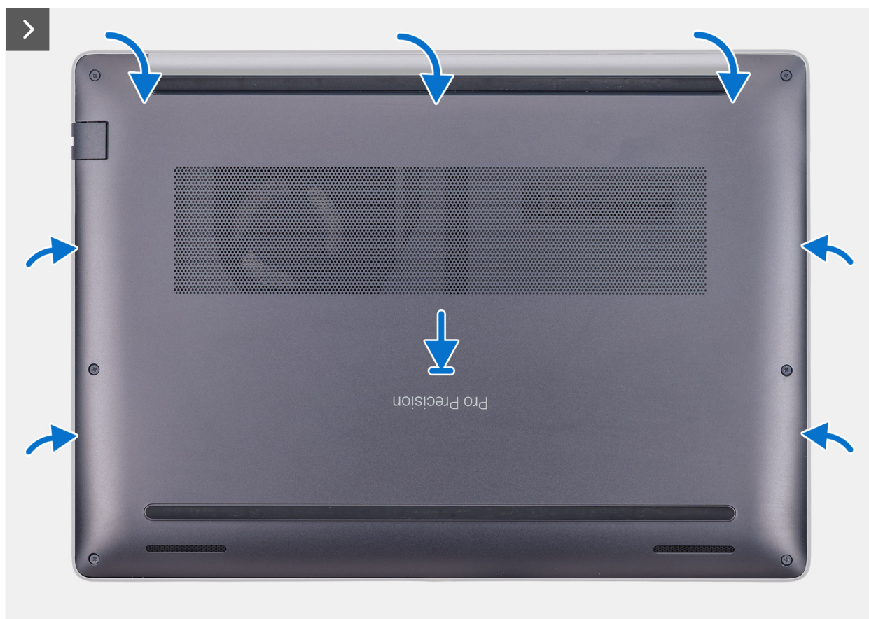
Rysunek 8. Instalowanie pokrywy dolnej
