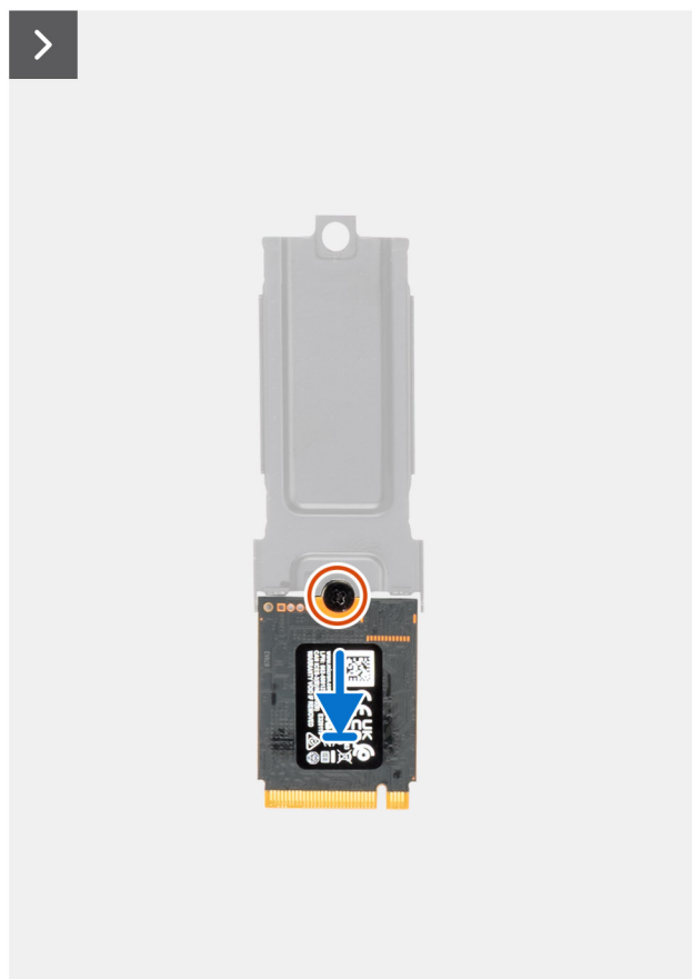
Rysunek 11. Instalowanie dysku SSD 2230
