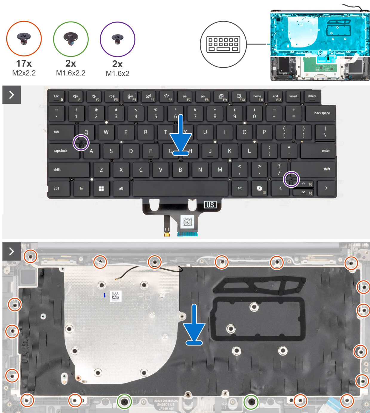
Rysunek 71. Instalowanie klawiatury
