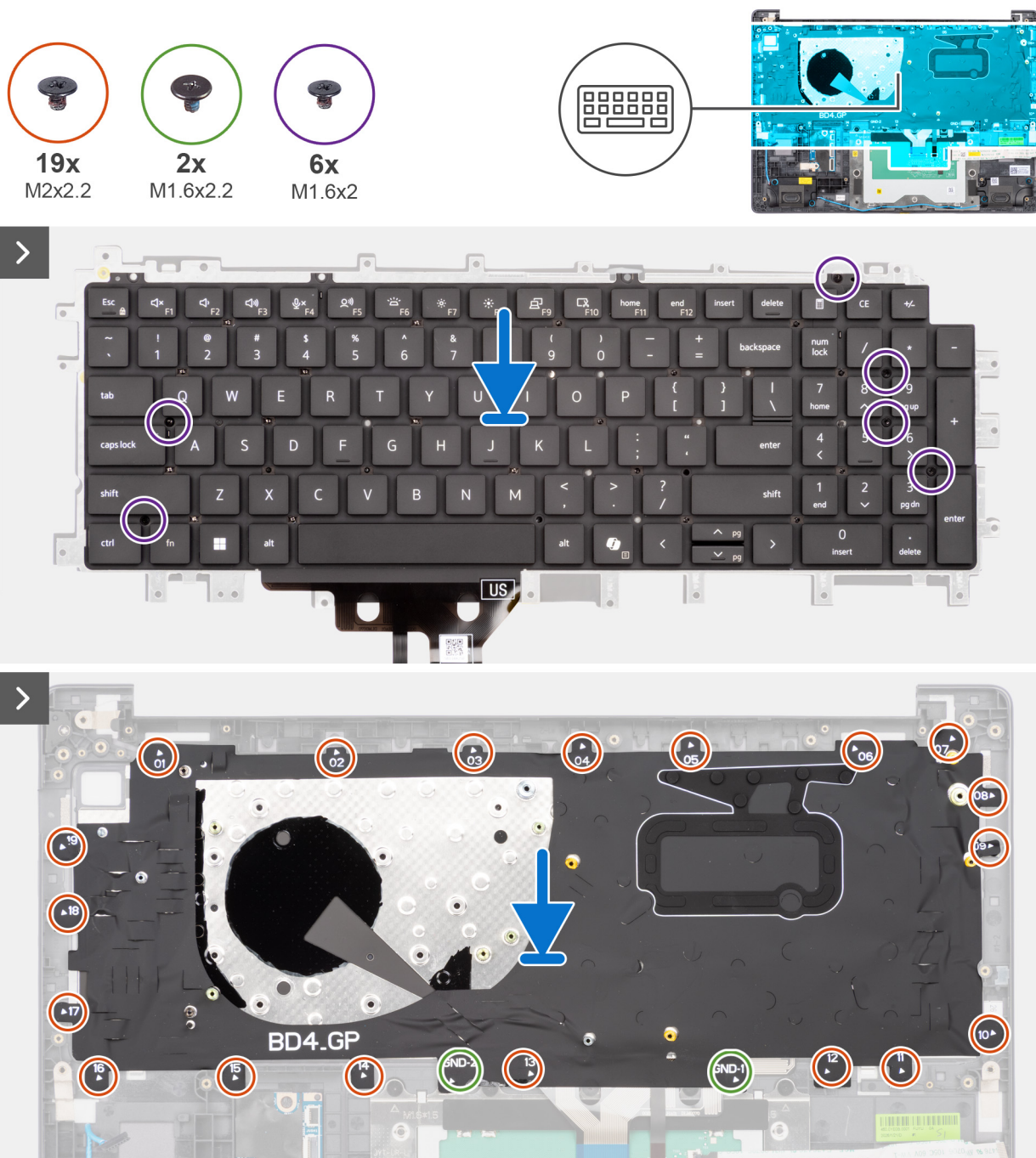
Rysunek 73. Instalowanie klawiatury
