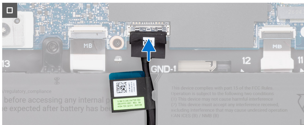
Rysunek 7. Podłączanie kabla baterii
