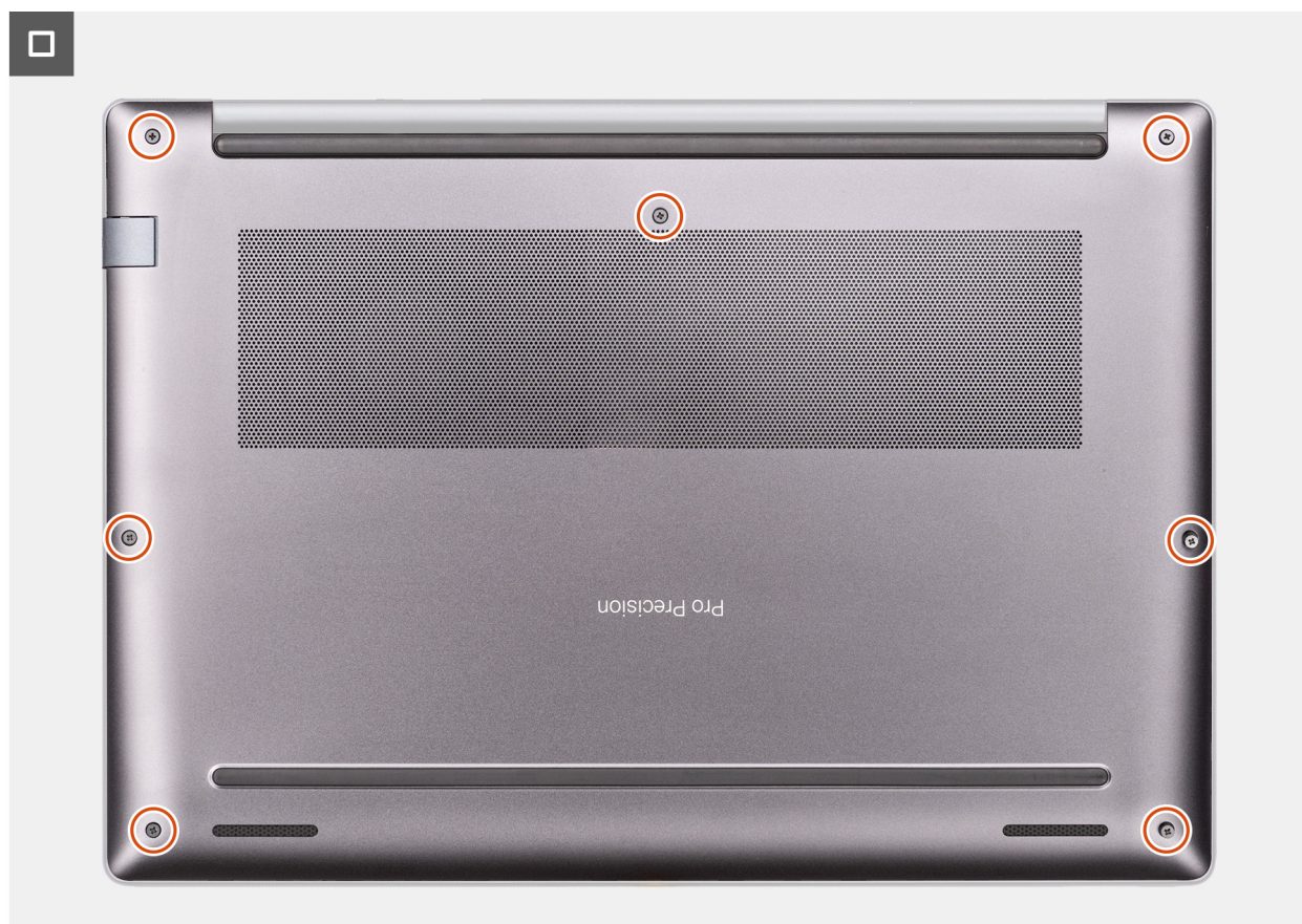
Rysunek 9. Instalowanie pokrywy dolnej
