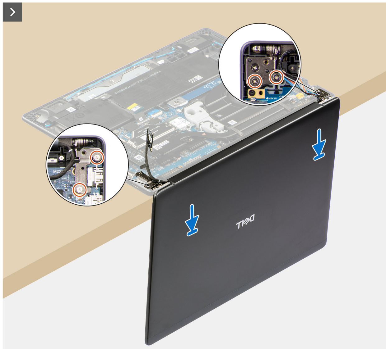
Rysunek 41. Instalowanie zestawu wyświetlacza
