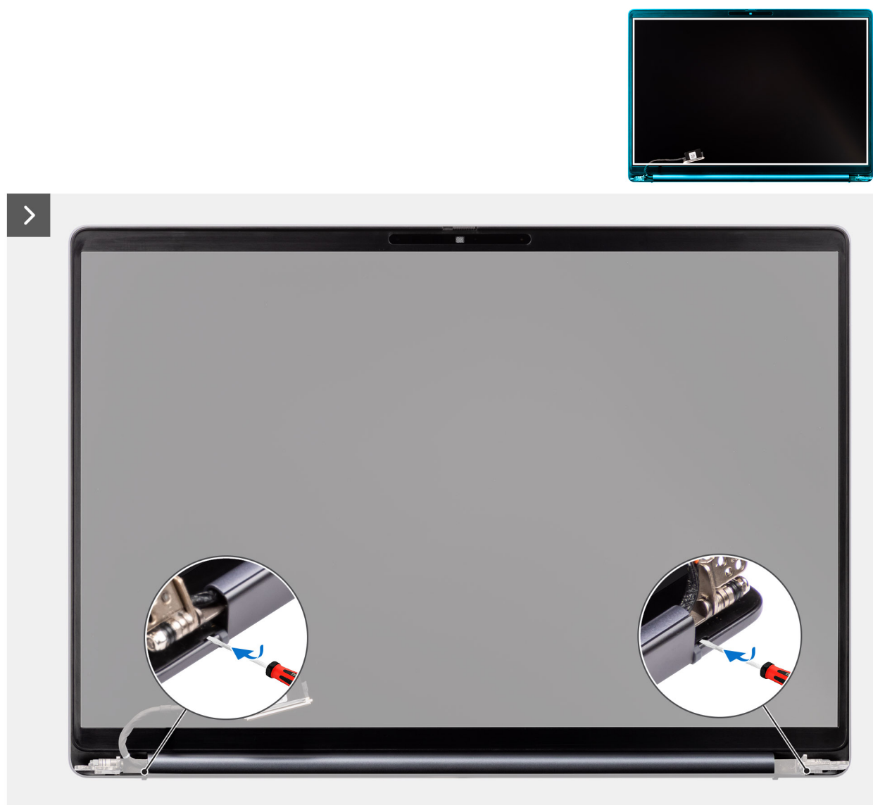
Rysunek 43. Wymontowywanie ramki wyświetlacza
