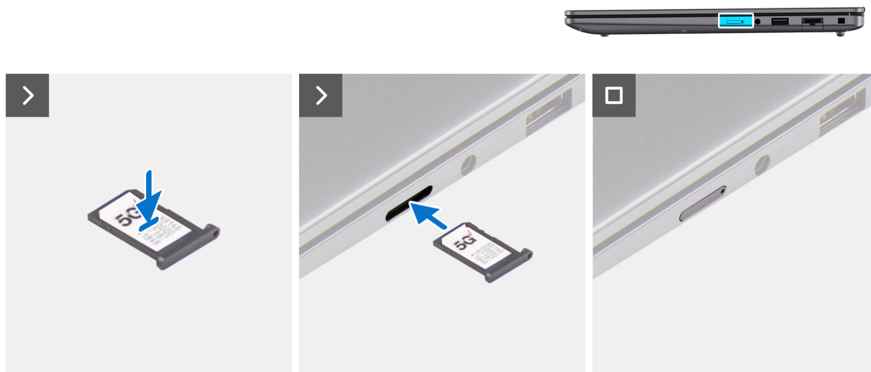
Rysunek 3. Instalowanie tacy na kartę nano-SIM
