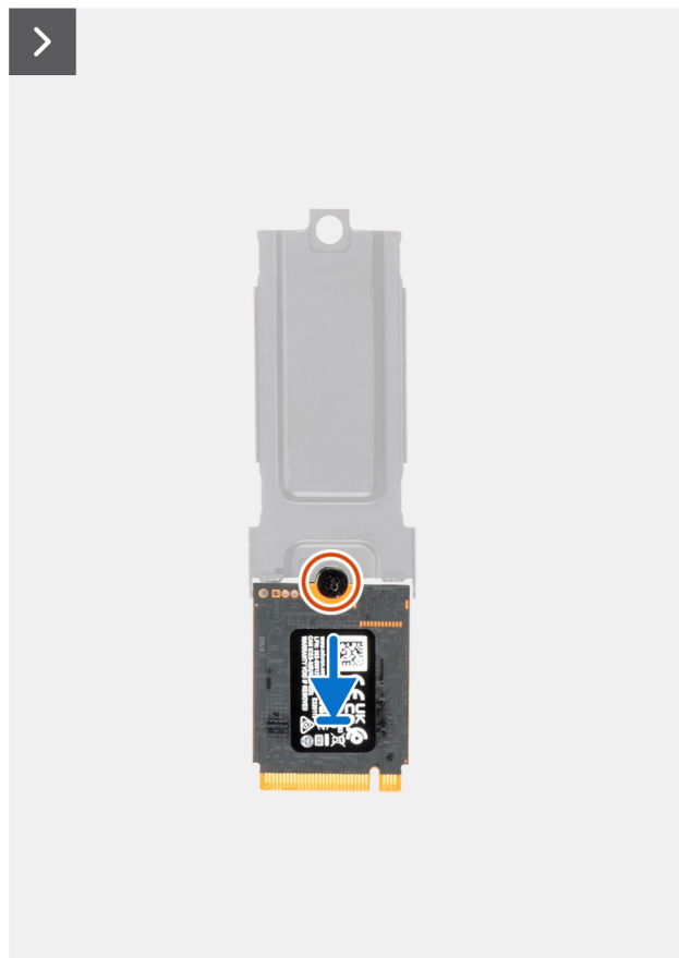
Rysunek 11. Instalowanie dysku SSD 2230
