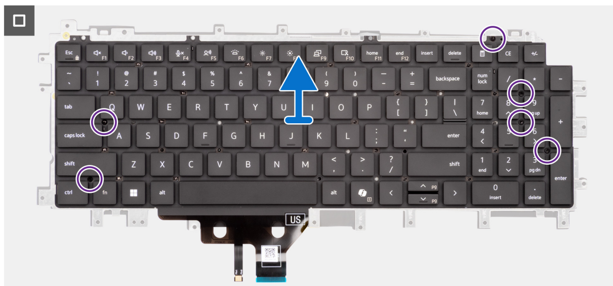
Rysunek 72. Wymontowywanie klawiatury
