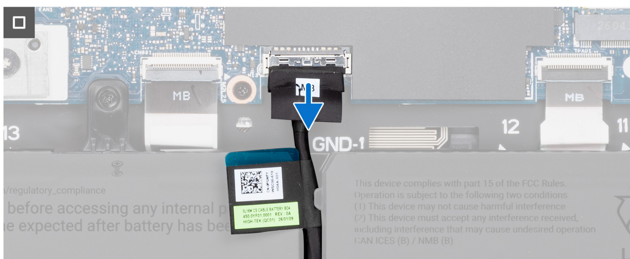
Rysunek 6. Odłączanie kabla baterii
