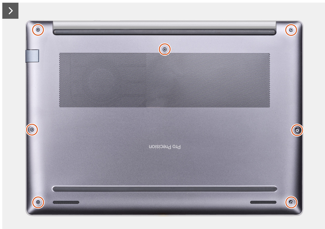
Rysunek 4. Wymontowywanie pokrywy dolnej
