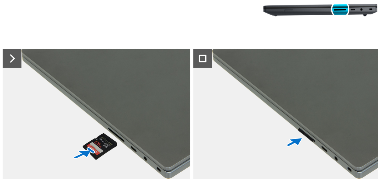
Rysunek 4. Instalowanie karty pamięci
