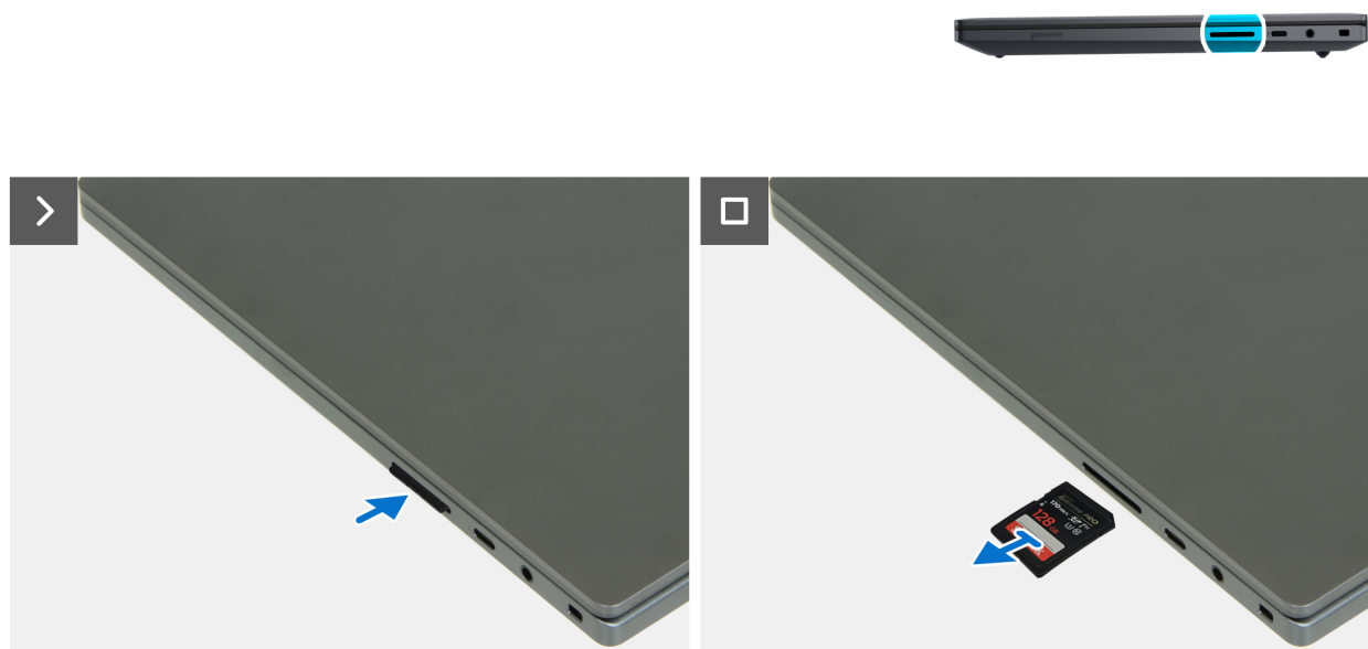
Rysunek 3. Wymontowywanie karty pamięci
