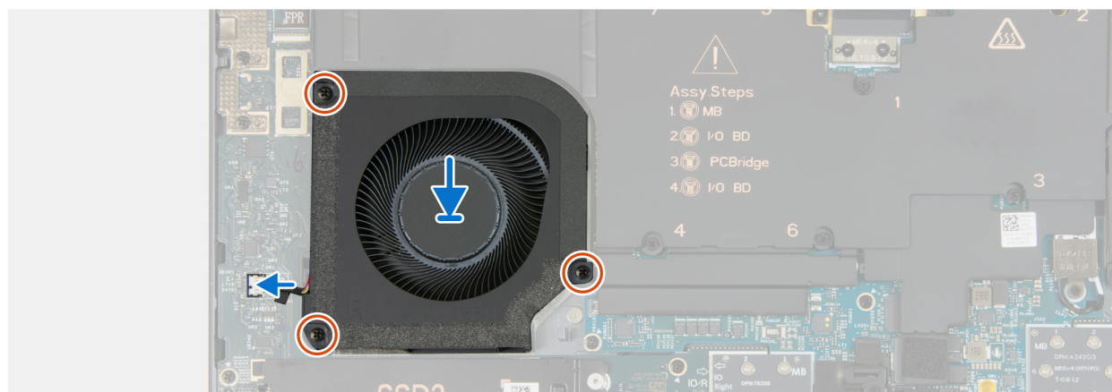
Rysunek 25. Instalowanie prawego wentylatora
