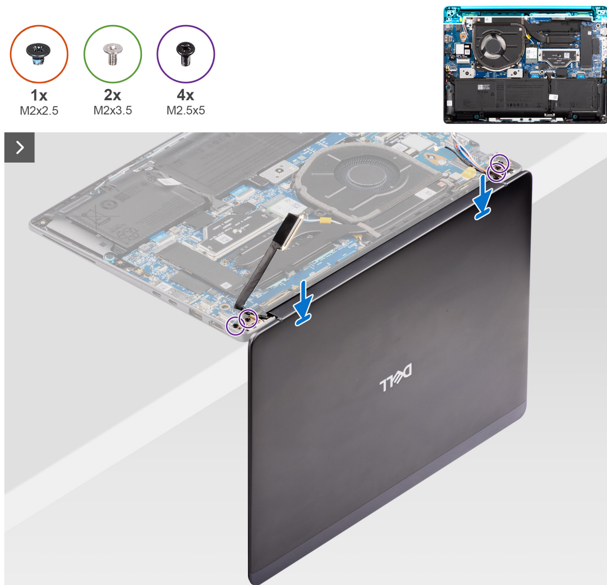
Rysunek 57. Instalowanie zestawu wyświetlacza
