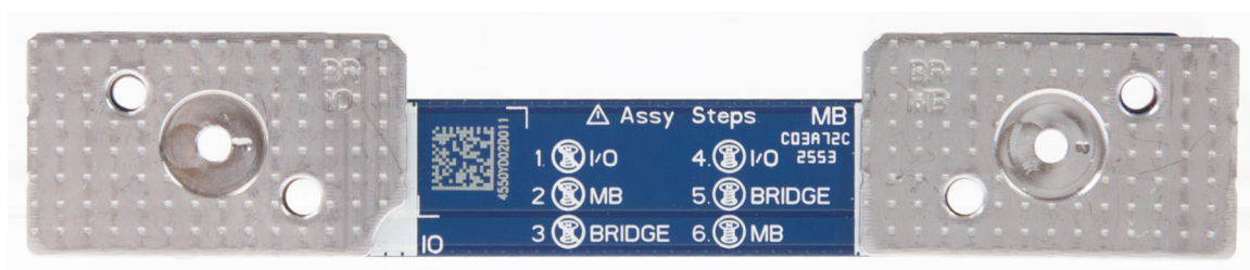
Rysunek 55. Kolejność instalacji
