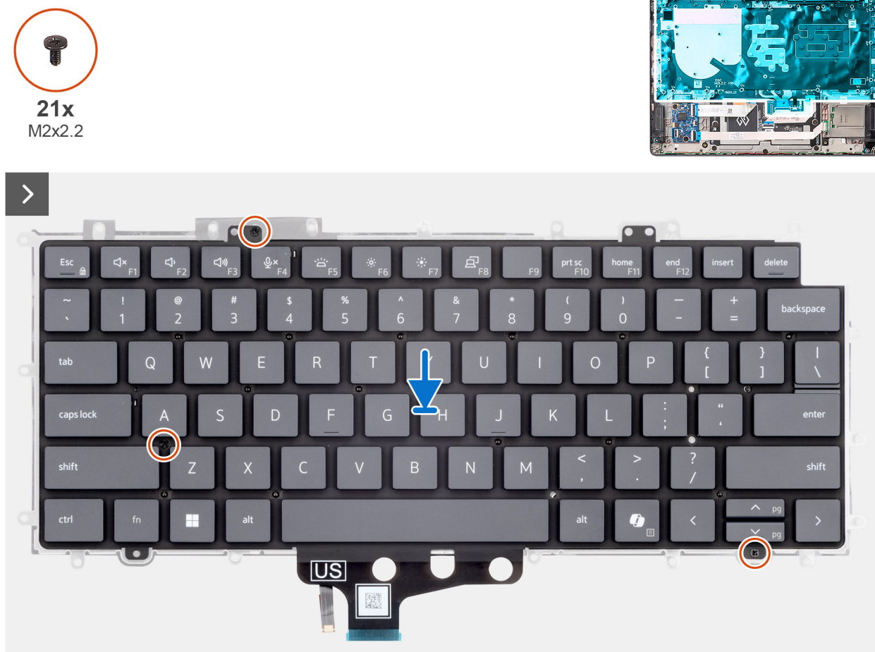
Rysunek 80. Installing the keyboard
