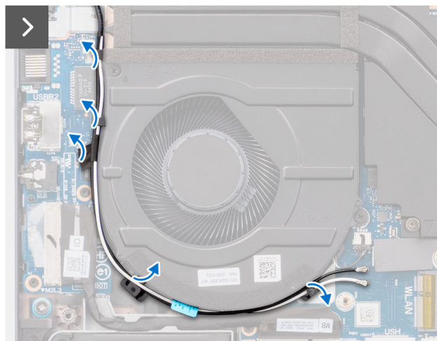
Rysunek 21. Removing the fan
