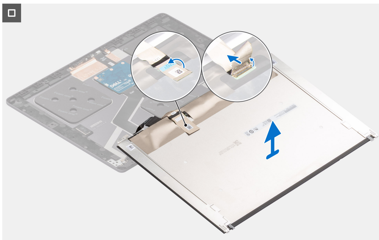
Rysunek 52. Removing the display panel
