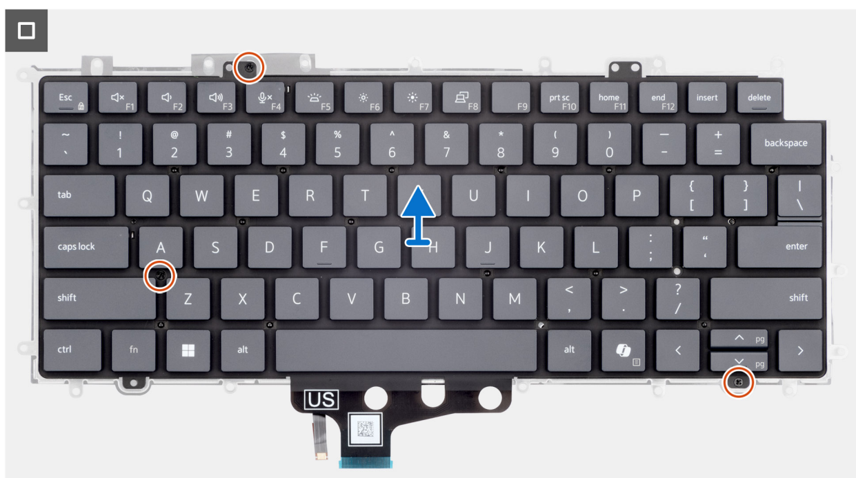
Rysunek 79. Removing the keyboard
