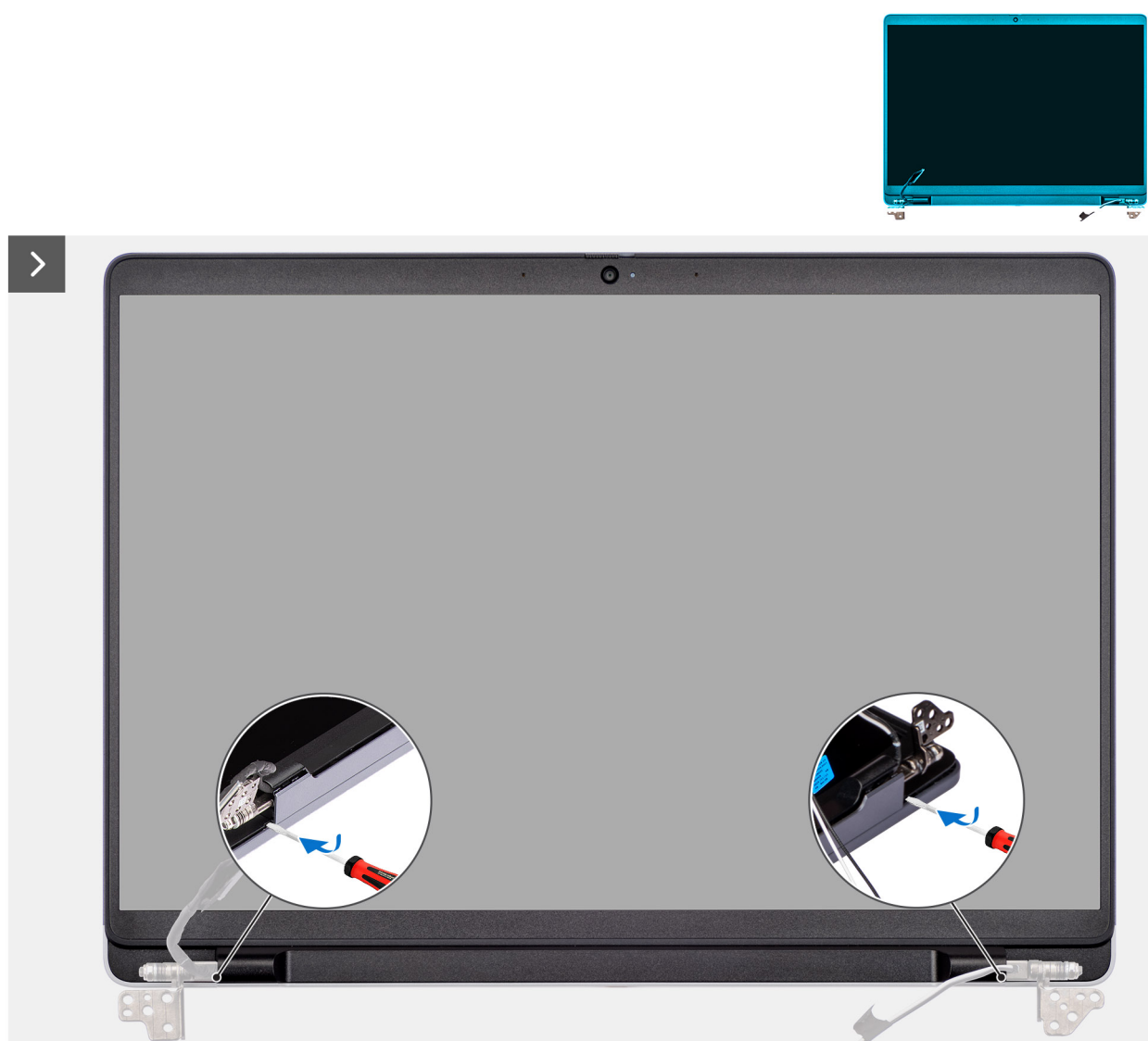
Rysunek 42. Removing the display bezel
