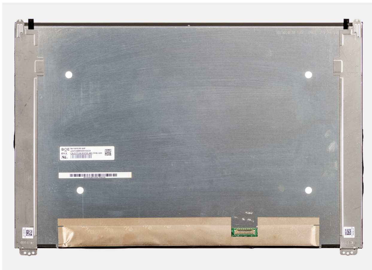
Rysunek 53. Removing the display panel
