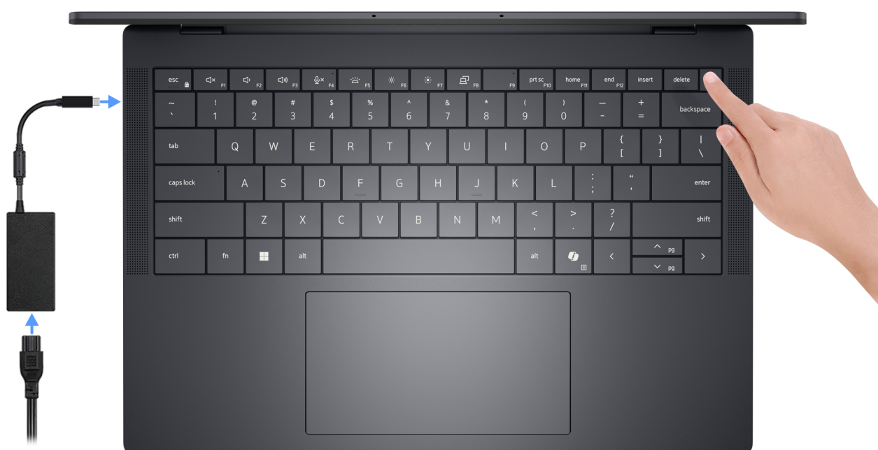
Rysunek 8. Podłącz zasilacz i naciśnij przycisk zasilania
